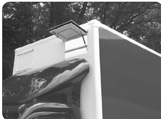
Kleine isolierte Klappe mit einer Gasfeder Small insulated flap with one gas strut
