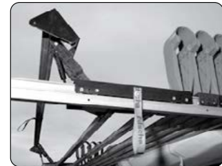
Zuversichtliches System der Kunststoffgelenke Tarpaulin folded reliably through joints
