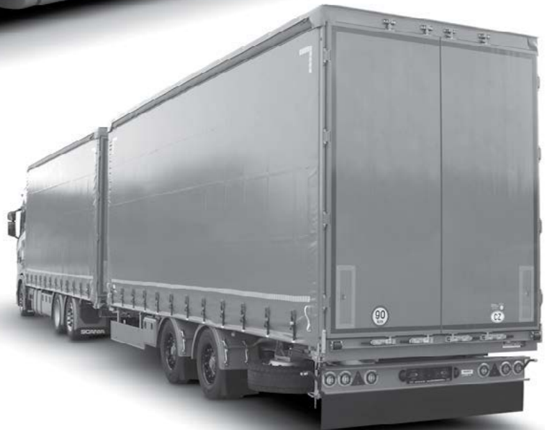
Lang-LKW CS MAX mit Aluminium-Hintertür und Aluminium-Überfahrbrücke Drive through tandem CS MAX with aluminum rear doors and ramp
