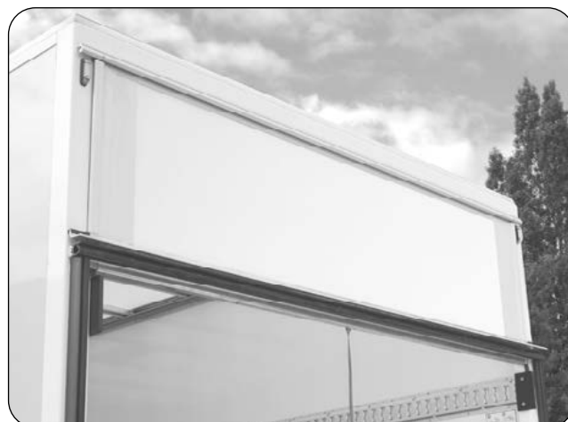
Klappe mit Regenleiste für Ladebordwand Flap with rain protection for hydraulic platform
