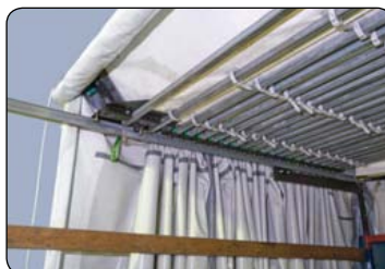
Střecha se bezproblémově shrnuje Tarpaulin folded reliably through joints
